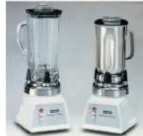
الشكل رقم (125) خلاط دوار Rotary blender (يمين)، خلاط من النوع التموجي Stoumacher (وسط)، خلاط دوامي Vortex mixer (يسار).
